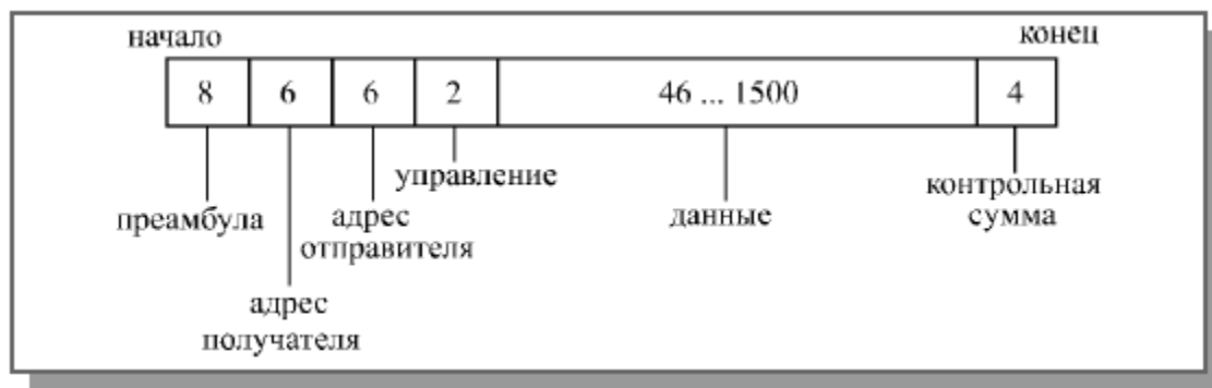
Рис. 6.1. Структура пакета сети Ethernet
