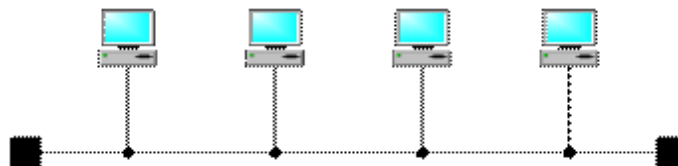
Рис. 2.1. Сетевая топология «шина»
