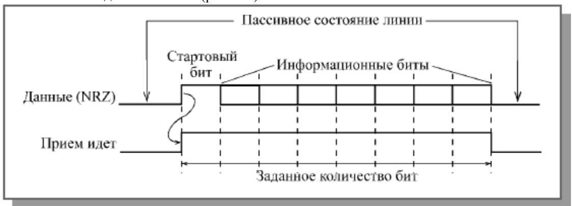
Рис. 4.3. Определение окончания последовательности при коде NRZ
